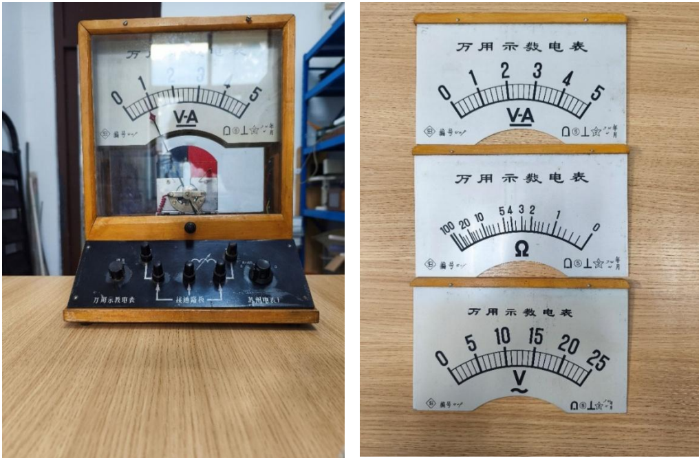
复旦大学物理学系 万用示数电表（电动式）及可更换表盘
